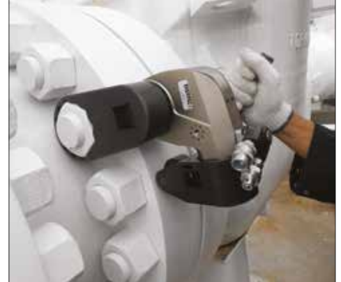
▲ Llave dinamométrica S11000X personalizada con conexión de par de apriete y rodillo de reacción personalizados.
