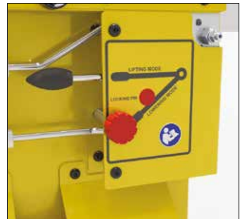
▲ Detalle del gato Cube Jack con palanca de elevación y descenso, y perilla de bloqueo.
