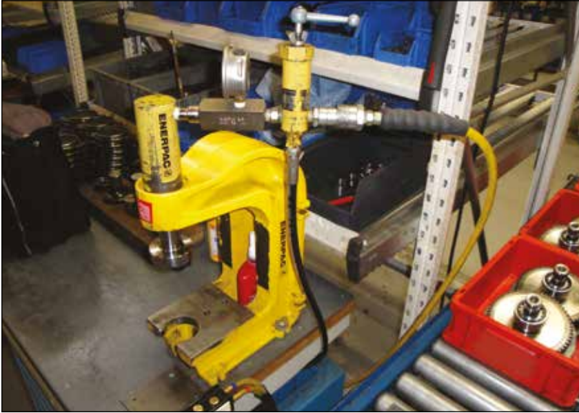
▲ Cilindro RC-308 montado en una prensa de husillo A-330 accionado por una bomba neumática PATG-Turbo para un prensado controlado de los rodamientos de las ruedas dentadas en telares. La válvula de alivio de presión V-152 controla la fuerza de presión.
