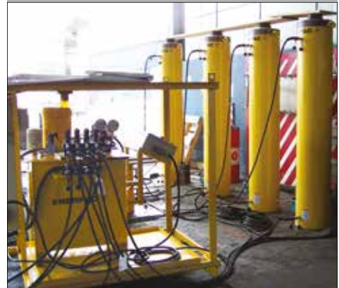
▲ Cilindros personalizados de 500 toneladas con 1,83 m de carrera para la elevación de palas de cuerda eléctrica.
