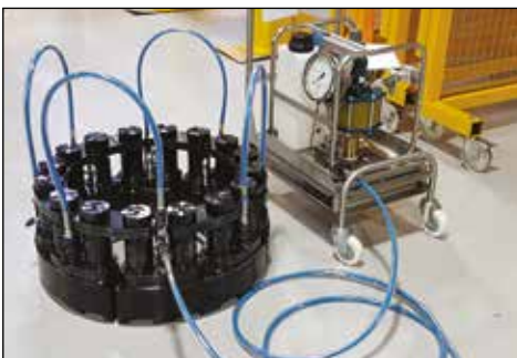
◀ El sistema de tensionado multiespárrago (MST) de Enerpac es capaz de tensionar todos los espárragos de una junta simultáneamente.
